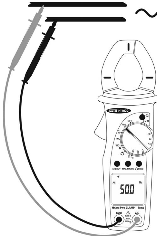
Abb. 5: Frequenzmessung mit Messleitungen
